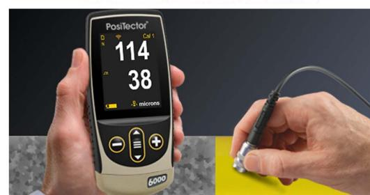
写真-6 塗膜と亜鉛メッキの厚みをそれぞれ表示するプローブ
