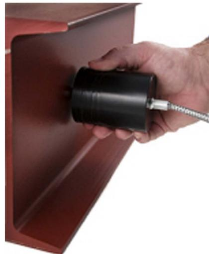
写真-11 厚膜用プローブの例
