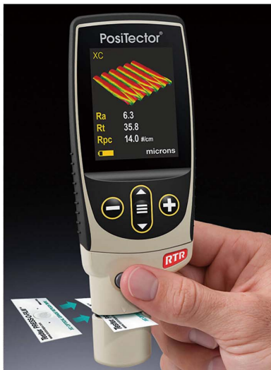
写真-17 2D および 3D 分析をする測定器
