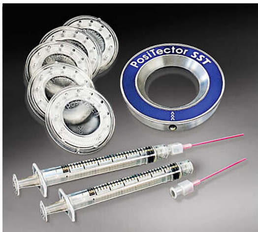
写真-22 マグネット固定方式のプレスルパッチ (左上：パッチ、右上：マグネットリング、下：注射器と金属針を使わない樹脂製のフレキシブルなニードル)
