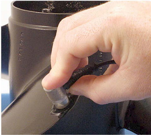
写真-43 超音波厚さ計による測定の様子
