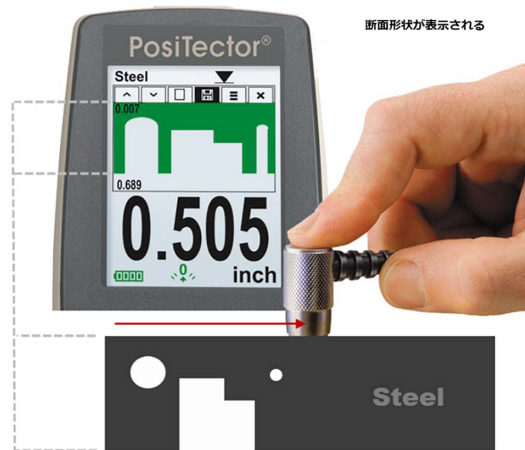
第 49 図 B スキャンによる素材中の穴やくぼみの表示のされ方
