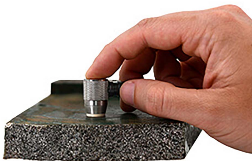
写真-47 減衰性材料をより低い周波数の超音波により測定する様子
