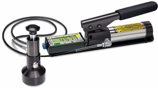
写真－54 手動式でありながら張力増加速度がデジタル表示される試験機の例
