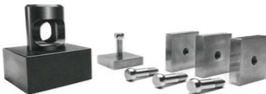
写真-57 タイルの接着剤固定試験用ドリー
