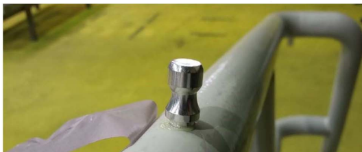
写真-55 パイプ形状に取り付けたφ10mm ドリー
