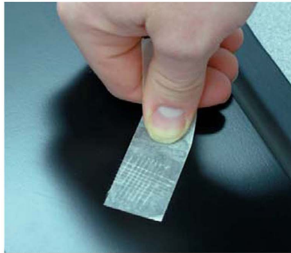
写真- 50 クロスカット法による試験の様子
