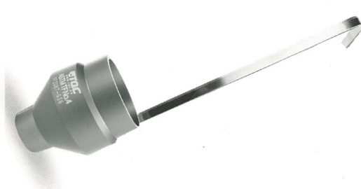
写真-68 Ford Cup の例(ディップタイプ)
