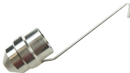
写真－64 ISO Cup の例 (ディップタイプ)
