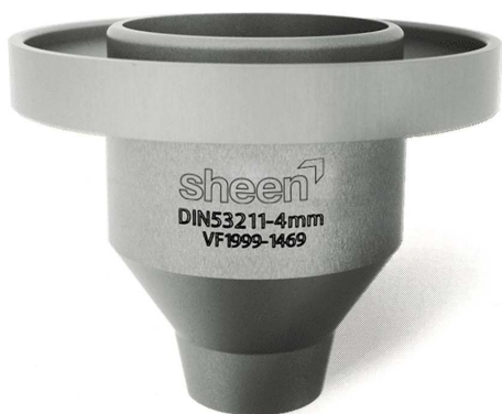
写真-65 DIN Cup の例(スタンド併用タイプ)
