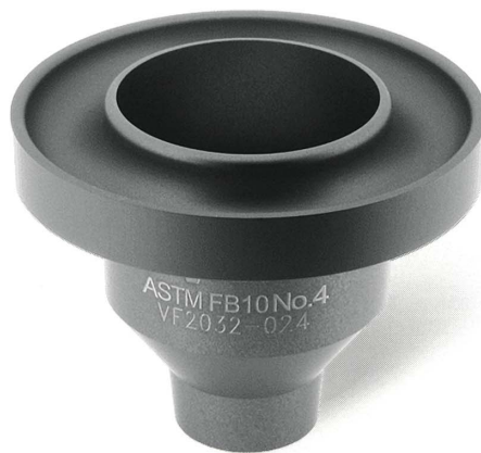
写真-67 Ford Cup の例(スタンド併用タイプ)
