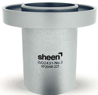
写真－63 ISO Cup の例 (スタンド併用タイプ)
