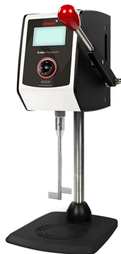
写真-62 クレブス・ストーマー粘度計の実機例
