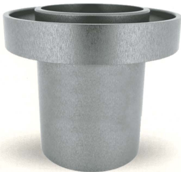
写真-58 フローカップの例 (ISO Cup)
