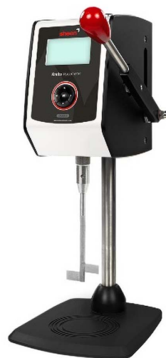
写真-15 ストーマー(クレブス)回転式粘度計
